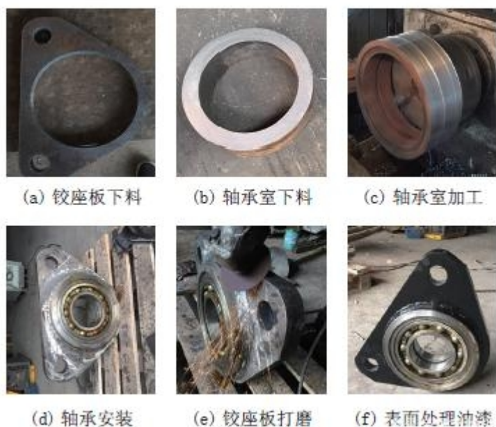
图 5 异型滑轮制造工序
