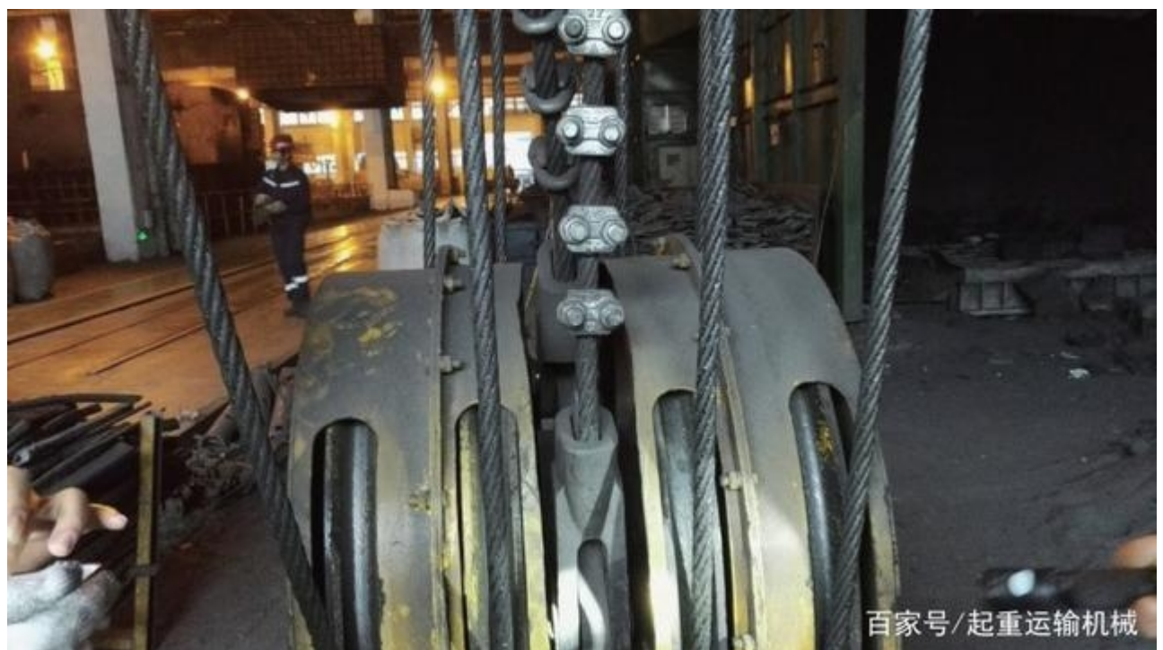
图 7 5 倍率异型滑轮钢丝绳起升系统
