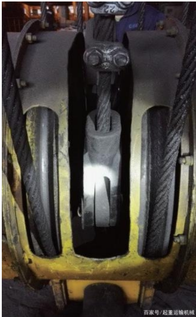
图 6 3 倍率异形滑轮钢丝绳起升系统吊钩组
